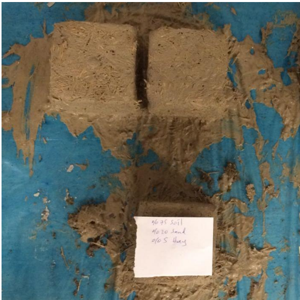
Fig. 5 Cubic specimens of set N.1.
