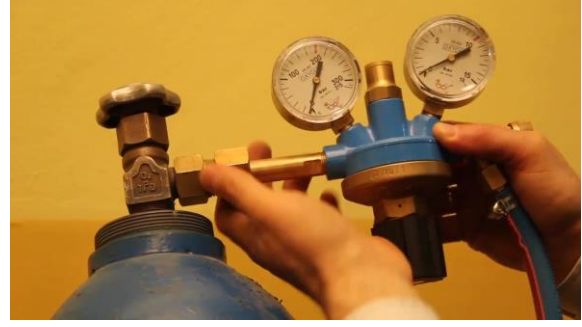
Şekil 1. Oksijen tüpüne manometrenin takılması.
