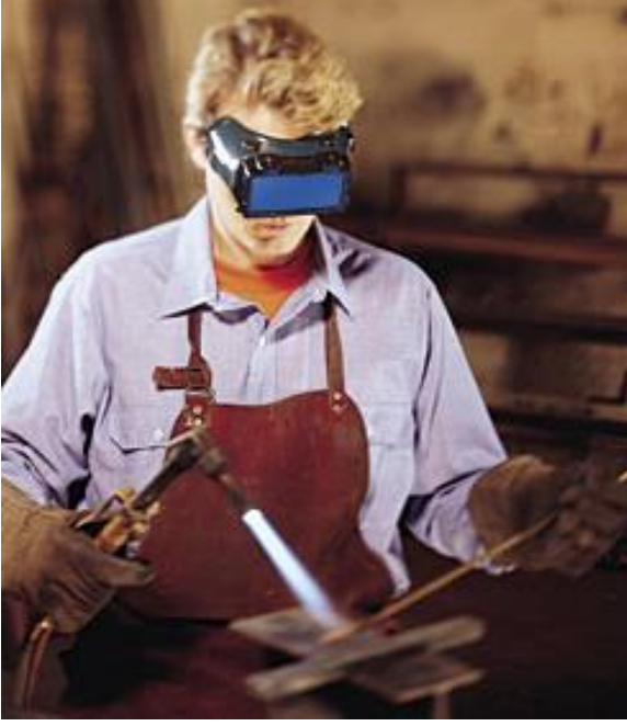
Şekil 2. Korucu donanımlarla oksi gaz kaynağı yapmak
