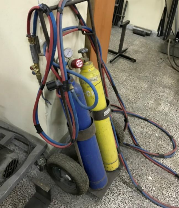
Şekil 5. Oksi asetilen kaynak tüplerinin kullanılacak yere arabayla taşınması.
