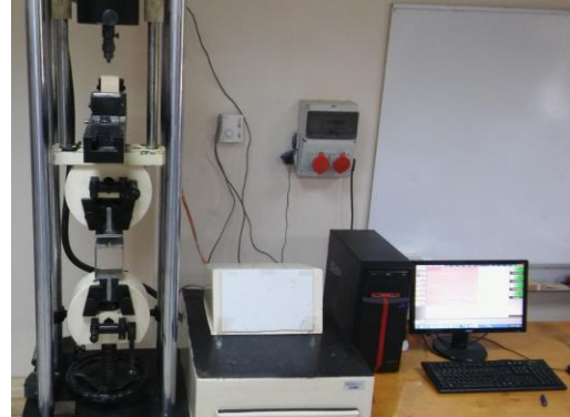
Şekil 1. Janka sertlik testinin belirlenmesinde kullanılan test cihazı
