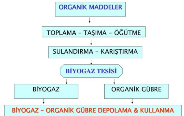
Şekil 1. Biyogaz Üretim Akış Şeması
