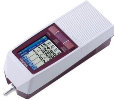
Şekil 3. Deneyisel çalışmada kullanılan yüzey pürüzlülük ölçüm cihazı
