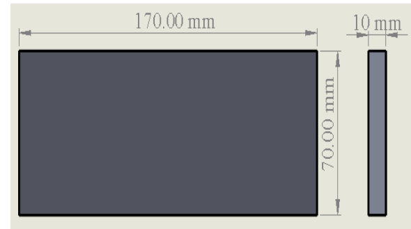
Şekil 1. Deneysel çalışmada kullanılan Hardox 400 malzemesinin ölçüleri
