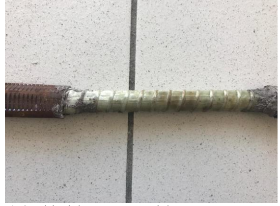
Şekil 3. Birinci deney numunesi deney sonrası görünümü
