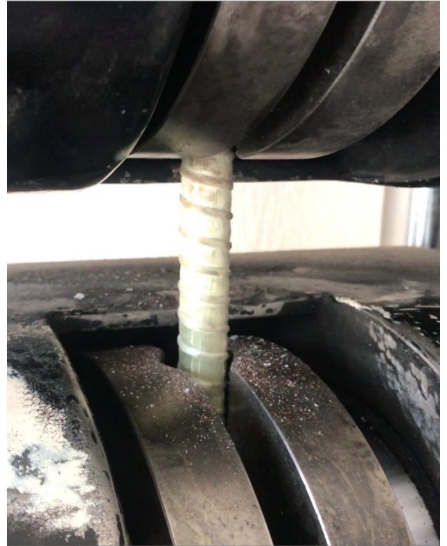
Şekil 4. İkinci deney numunesi çekme aletine yerleştirilmesi
