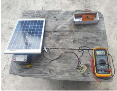
c) Panelden alınan gerilimi 13.2 V'a düşürecek devrenin denemesi Şekil 3. Sistemin çanta haline getirilmeden önce denemesi
