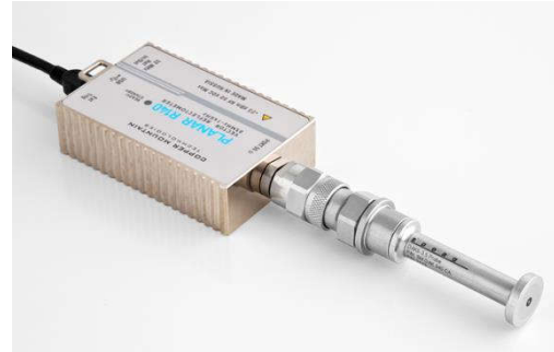
Şekil 1. Fantom Elektriksel Değerlerinin Ölçülmesinde Kullanılan Reflektometre
