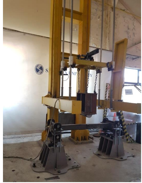
Şekil 3.1. Kompozit kirişin düzeneğe yerleştirilmesi
