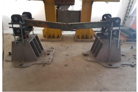
Şekil 3.2. Darbe sonucu oluşan deformasyon
