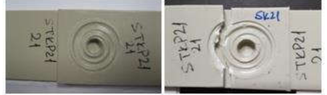
Şekil 11. T2 ile kaynaklanan en yüksek kaynak dayanımına sahip numunenin çekme testi öncesi ve sonrası fotoğrafları
