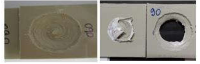
Şekil 10. T1 ile kaynaklanan en yüksek kaynak dayanımına sahip numunenin çekme testi öncesi ve sonrası fotoğrafları
