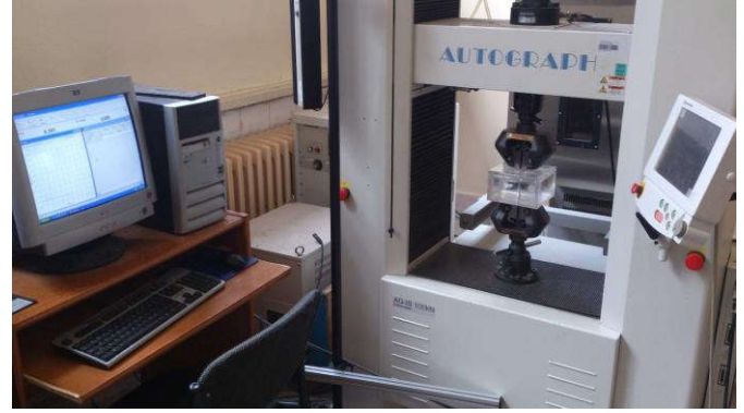
Şekil 4. Çekme deney cihazı yardımıyla SSRT metodunun uygulanması
