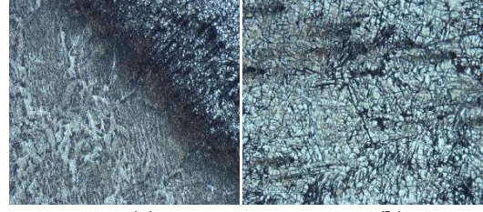
Şekil 6.SiC katkılı MAG kaynak yöntemiyle birleştirilen numunenin mikroyapısı. a) ITAB (100X) b)Kaynak metali mikroyapısı (200X).
