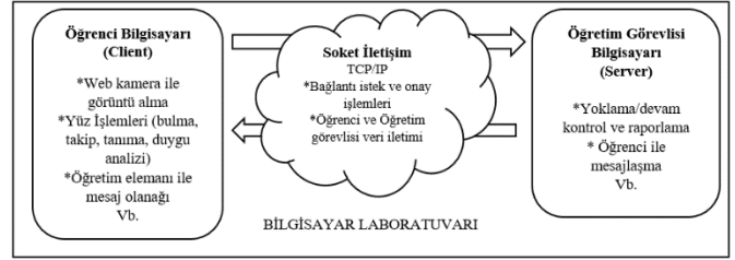
Şekil 2. Sistemin çalışma yapısının blok diyagramı
