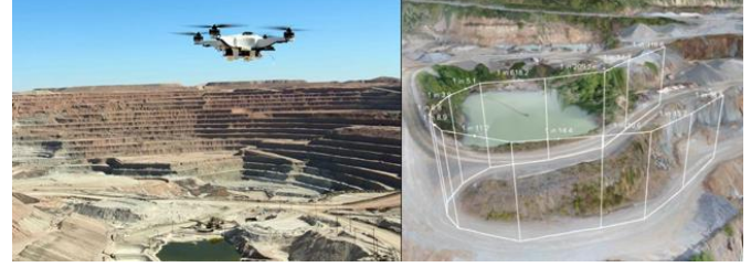
Şekil 6. İHA ile maden ocağı ve ocak yollarının kontrolü
