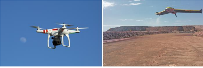
Şekil 1. Döner kanatlı ve sabit kanatlı İHA
