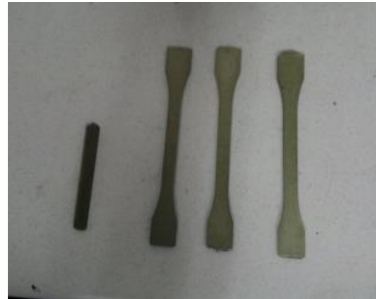
Şekil 1. Çekme ve darbe numuneleri
