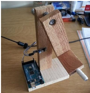
Şekil 4 Pedala TCRT5000 ve Arduino Mega R3 entegre hali
