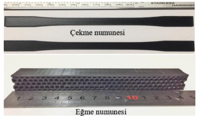
Şekil 3. Eriyik yığıma modelleme yöntemiyle üretilmiş çekme ve eğme numuneleri
