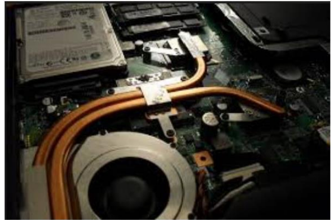
Şekil 10. Dizüstü Bilgisayara Yerleştirilmiş Isı Borusu [34]
