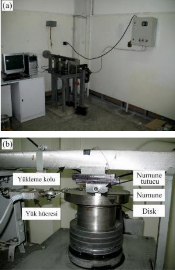
Şekil 1. Aşınma deney düzeneğinin a) fotoğrafı b) deney numunesinin ve aşındırıcı diskin yakından görünümü
