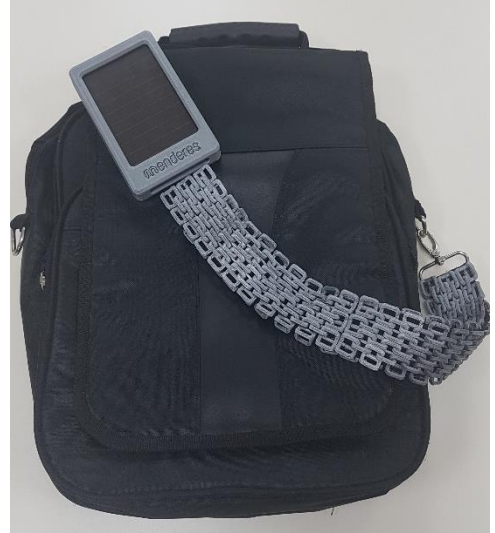
Şekil 8. 3D filamentli fotovoltaik enerji üretebilen çanta
