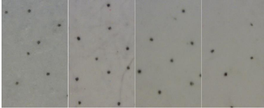
Resim 5. 170g/m 2 ve 300g/m 2 Parlak kuşe, 400 g/m 2 karton ve 80g/m 2 1.hamur kağıtlara yapılan dijital baskılardan mikroskop ile 200 defa büyütülerek çekilen %1'lik nokta görüntüleri
