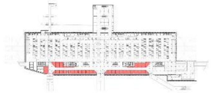
Resim 21. Ankara Tren Yeni Gar -2. Bodrum Kat Planı (Ticari Alanlar Kırmızı Renk İle İfade edilmiştir) [27]
