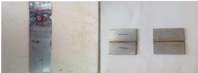
Şek 4. a) TIG kaynaklı numune b) Lazer kaynaklı numuneler
