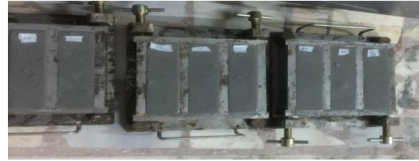
Şekil 2.1 Harç karışımlarının 4*4*16 cm ebatlı çelik kalıplara yerleştirilmesi.
