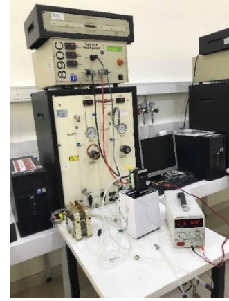
Resim 2- Yakıt Pili Performans Test İstasyonu
