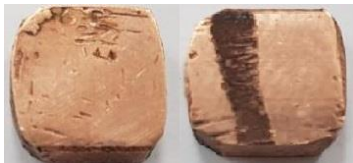
Şekil 3. Bakır plakanın aşınmadan önceki ve sonraki hali
