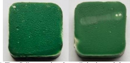
Şekil 4. Floro Polimer esaslı malzeme ile kaplanmış bakır plakanın aşındırılmadan önceki ve sonraki hali
